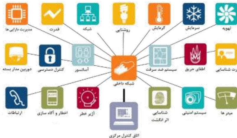
شکل (۸-۲) تجهیزات قابل کنترل از طریق BMS
