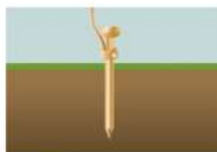
شکل (۵-۶) اجرای ارت سطحی به روش میله‌ای و شبکه‌ای
