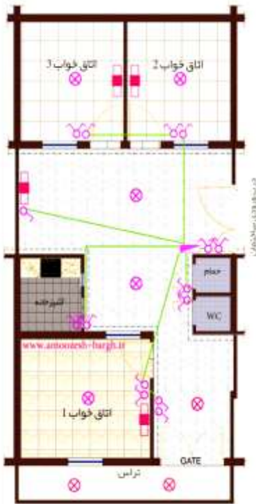
شکل (۴-۲۳) نقشه برق ساختمان لوله‌های برگشتی
