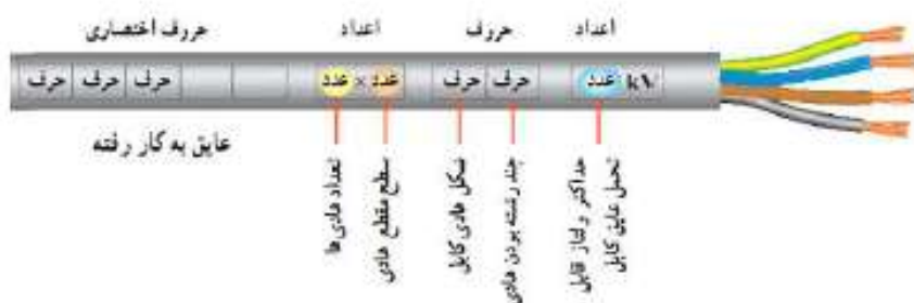
شکل (۲-۷) مشخصات نوشته‌شده روی کابل
