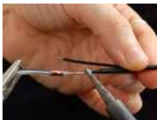
شکل (۲-۸) یک نمونه اتصال سیم با استفاده از لحیم
