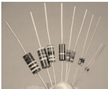
شکل ۱-۶- توان مقاومت به ترتیب از راست به چپ \frac{1}{8} ، \frac{1}{4} ، \frac{1}{2} ، \frac{1}{5} ، \frac{1}{10} و ۳ وات
