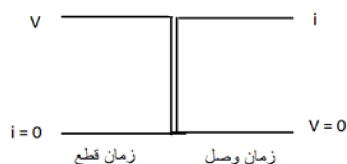
شکل (۱-۱) زمان سوئیچینگ کلید های نیمه‌هادی در حالت ایده‌آل
